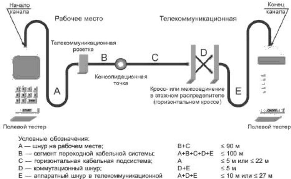
Рисунок 1 — Конфигурация тестирования модели канала
