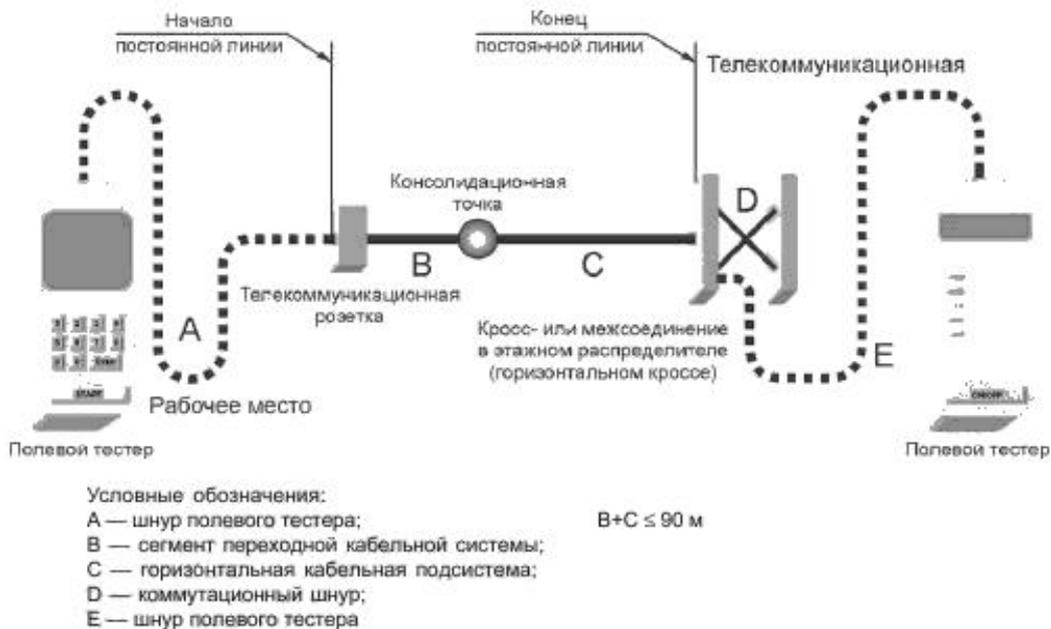
Рисунок 2 — Конфигурация тестирования модели постоянной линии
