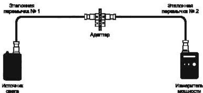
Рисунок 7 — Калибровки 2 и 3 — проверка качества тестовых шнуров
